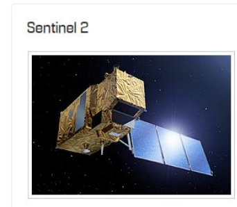
Optischer Sensor 10 – 60 m 13 Spektralkanäle Sentinel 2B gestartet am 07.03.17
