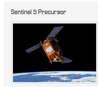
Spektrometer UV bis nah-infrarot globale Überwachung der Atmosphäre auf Spurengase
