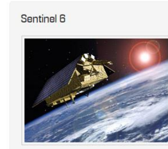
Satelliten-Altimeter Tidenfreie Messung des Meeresspiegels
