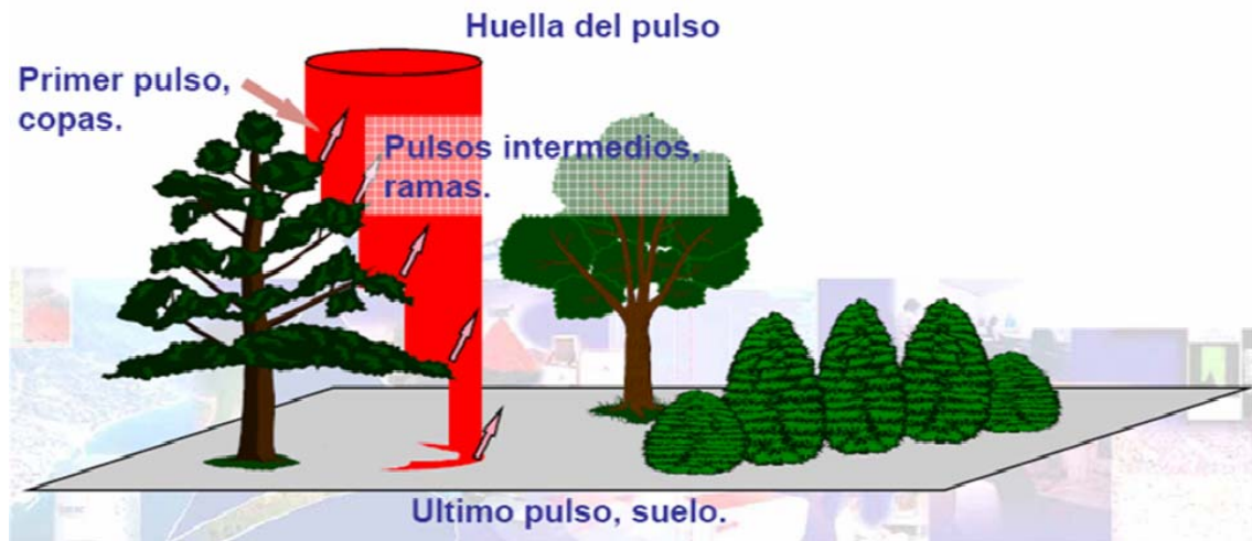
Figura 2.4. Esquema de retorno de pulsos láser.
