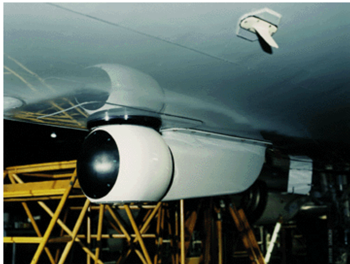
Figura 2.5. Sensor LiDAR montado en la panza de un avión.
